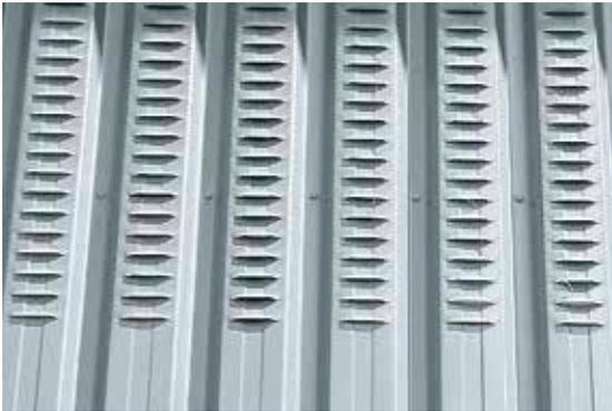
Lüftungsschlitze werden nur für LP20 Fassadenprofile hergestellt. Mit einem Abstand von 30 mm wird ein Öffnungsareal von 9% erreicht.
